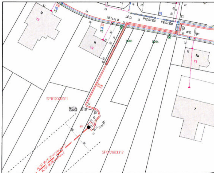
Abb.: Stromleitung der Syna GmbH (rot)
