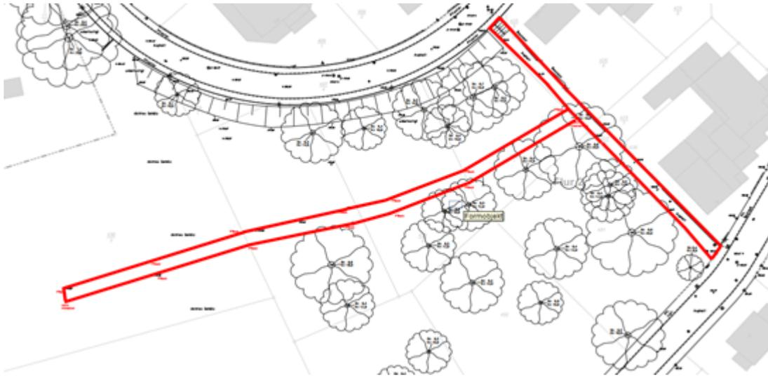
Die Schillerstraße oben, die Waldstraße unten. Quer (in Rot) verläuft der Mischwasserkanal und liegen die Kanalanschlüsse, rechts vertikal der Verbindungsweg, in dem die Hauptwasserleitung erneuert wird, mit der Treppe am oberen Ende. Skizze: Stadt Bad Soden am Taunus.
