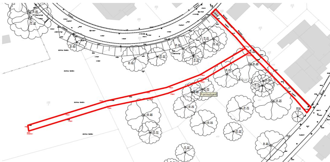
Die Schillerstraße oben, die Waldstraße unten. Quer (in Rot) verläuft der Mischwasserkanal und liegen die Kanalanschlüsse, rechts vertikal der Verbindungsweg, in dem die Hauptwasserleitung erneuert wird, mit der Treppe am oberen Ende.
