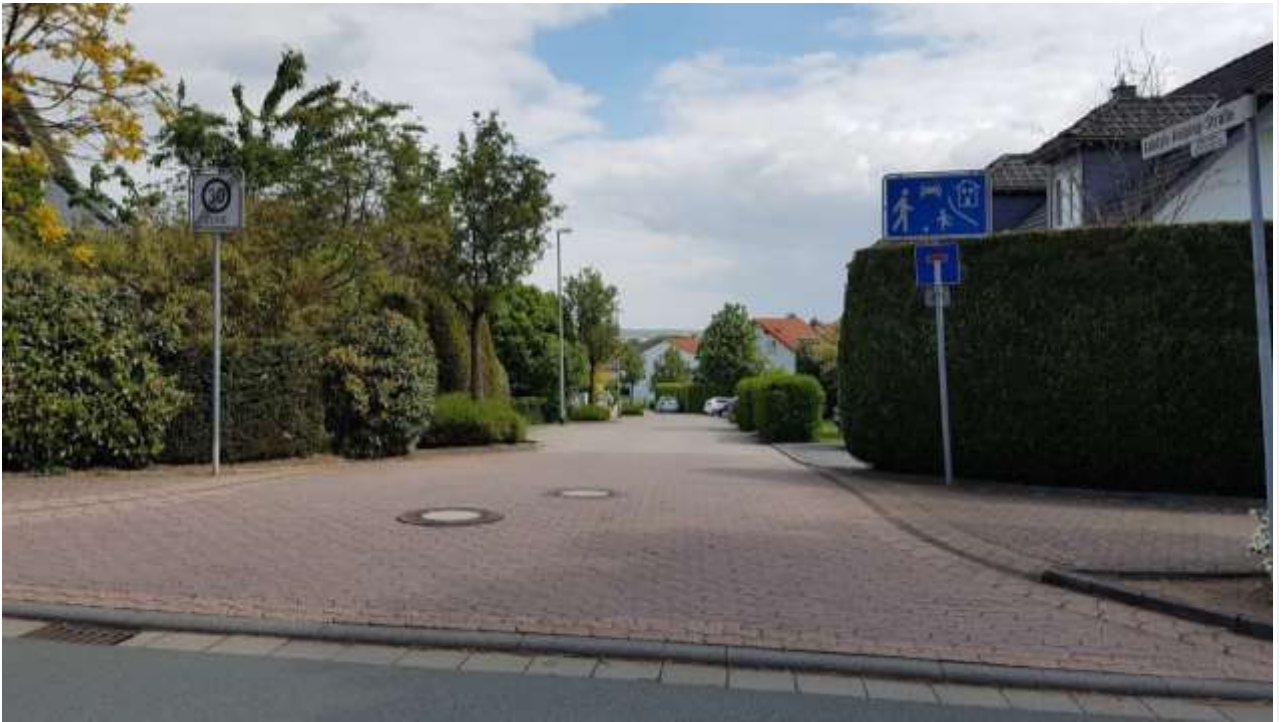
Abbildung 45: Beispiel Adolph-Kolping-Straße: Aufpflasterung im Einmündungsbereich (eigenes Foto)
